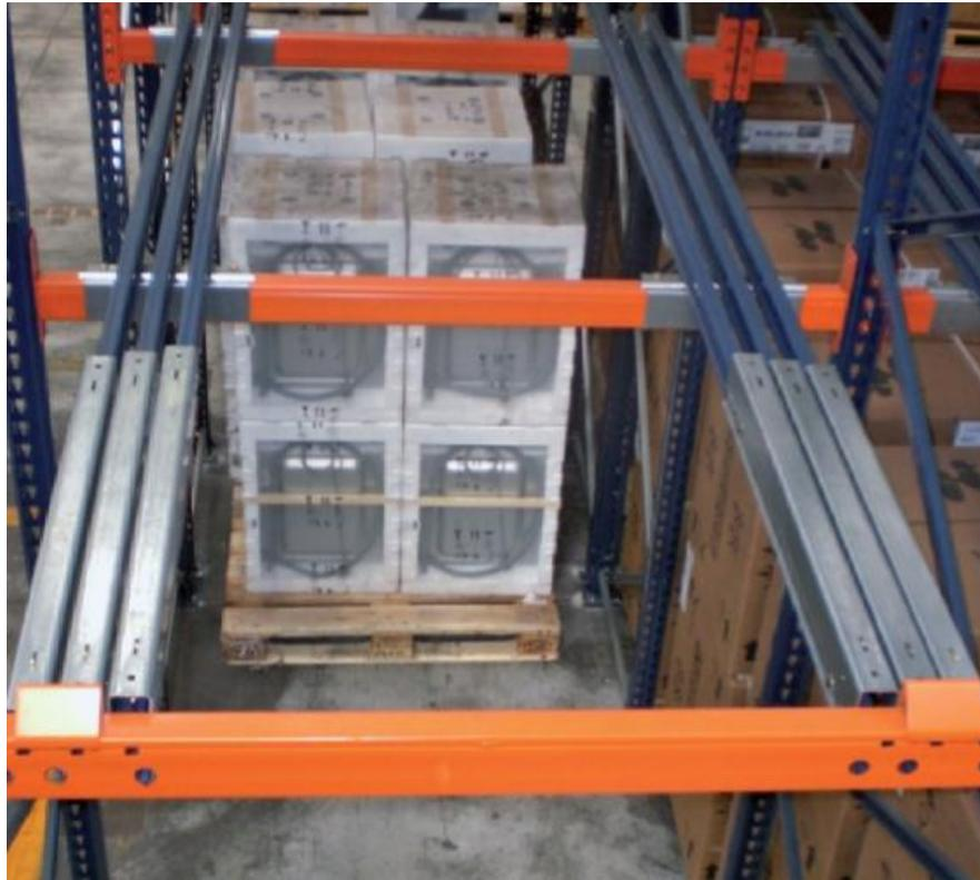
Figura 3.13 – Stoccaggio push-back per il "bianco" (SGM)
