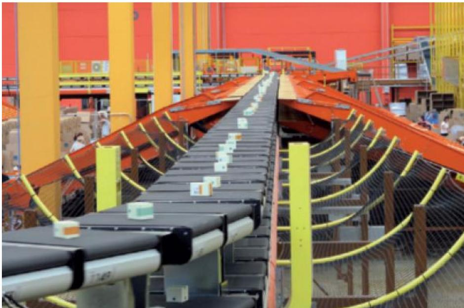
Figura 3.25 – Sorter a due livelli ("double-deck") utilizzato da *Thun*
