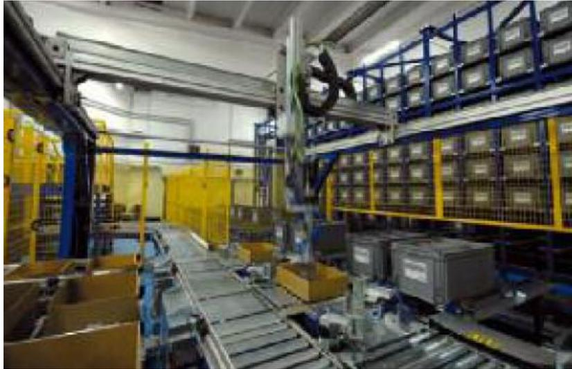
Figura 3.20 – Robot cartesiano per il picking (C.D. Verte)
