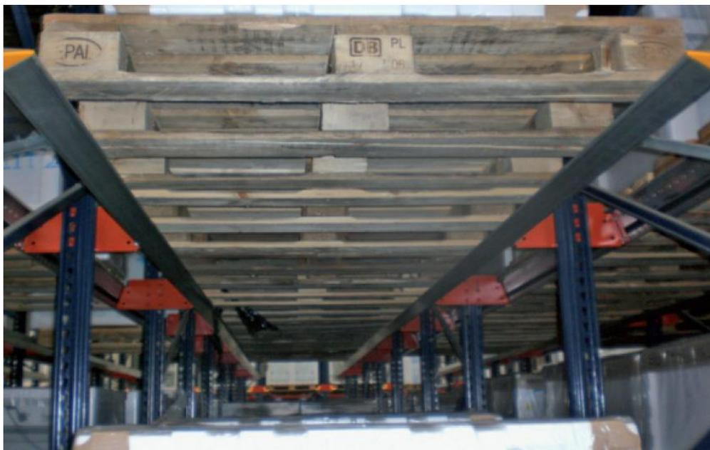
Figura 3.14 – Stoccaggio drive-in per il "bianco" (SGM): particolare delle mensole di appoggio
