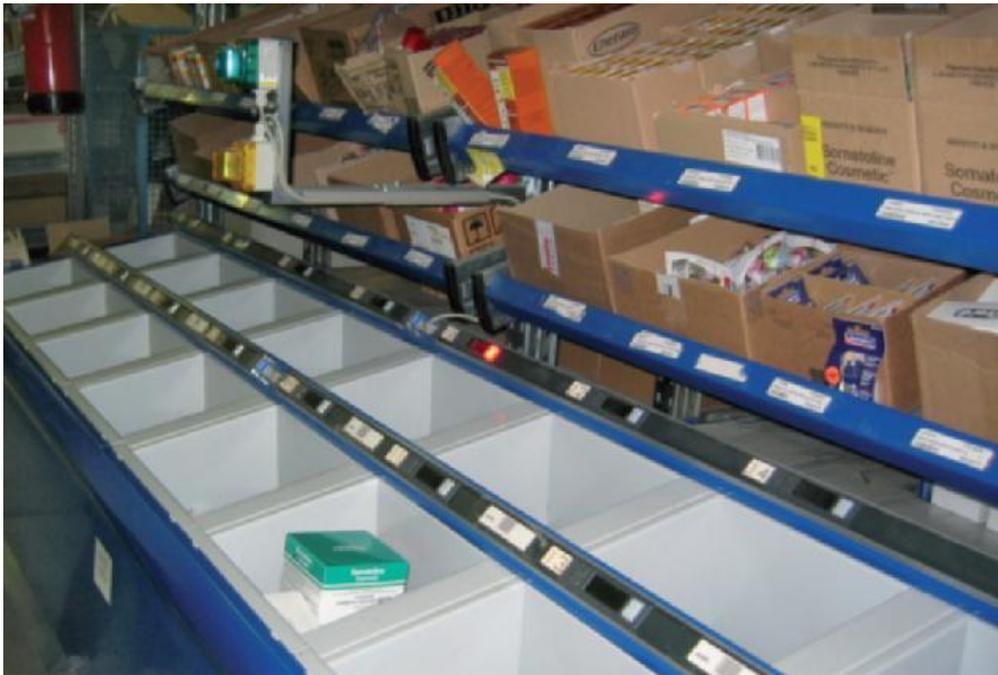
**Figura 3.3 – Sistema pick-to-box (Cef). Ogni codice viene letto mediante scan ring; dopo il prelievo, i picker inseriscono i prodotti nelle buche operando con logica put-to-light**
