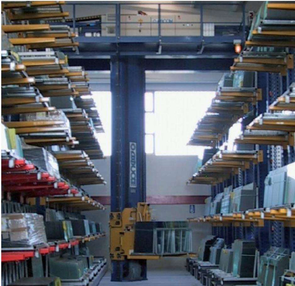
Figura 3.27 – Il trasloelevatore aereo implementato da *Novellini* asservito alle scaffalature mobili compattabili
