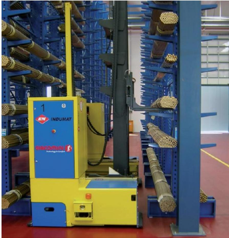
Figura 3.17 – AGV a guida laser (*Giacomini*): missione di prelievo in magazzino cantilever
