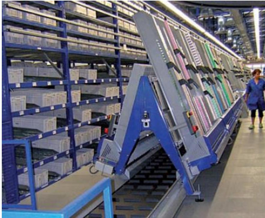
**Figura 3.1 – Particolare di un dispenser A-frame (*Unifarm*)**
