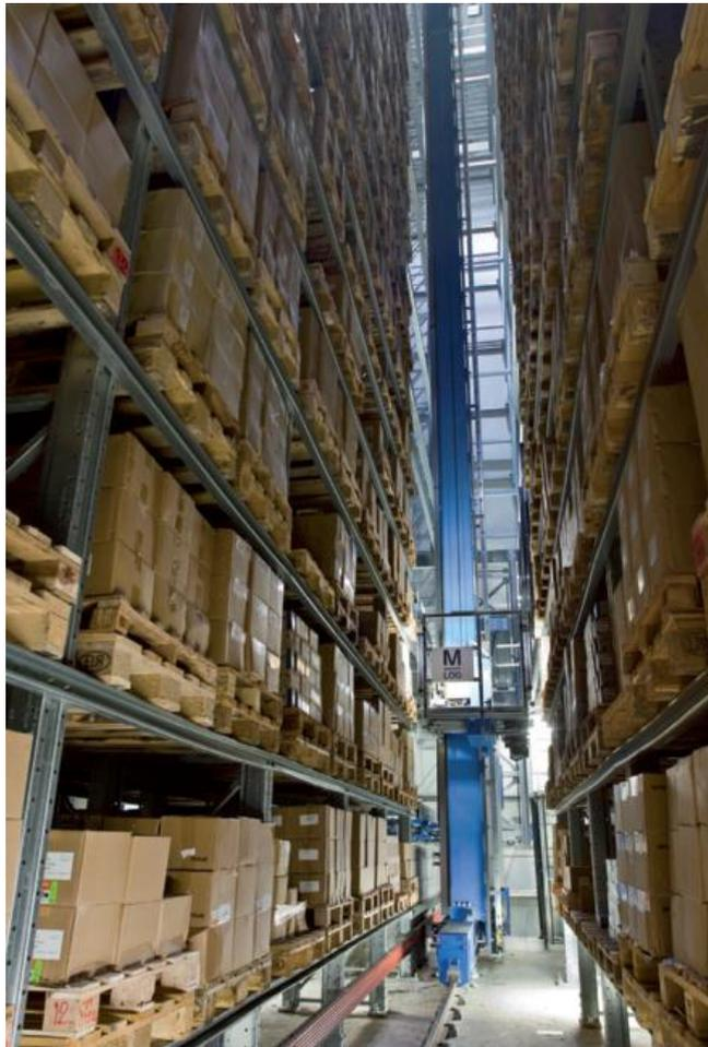
**Figura 3.8 – Trasloelevatore utilizzato da *Ambrovit***
