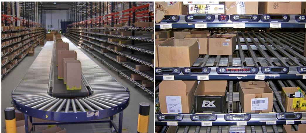
Figura 3.21 – Isola di prelievo in *Gamestop* (a sinistra) e particolare del sistema pick-to-light (a destra)
