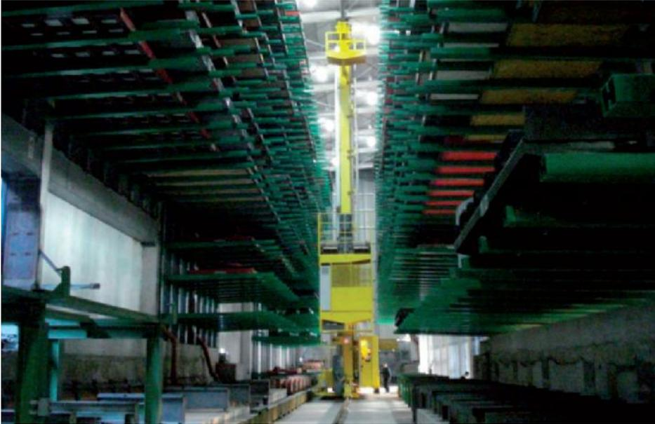
Figura 3.19 – Trasloelevatore ad alta portata (*Fonderia Boccacci*)
