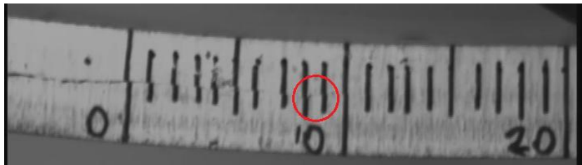
Figura III.15. Determinazione dell'avanzamento del difetto in una prova di delaminazione in modo II: l'ultima tacca della griglia laterale che risulta "spezzata" dall'avanzamento del difetto rappresenta la posizione di cricca
