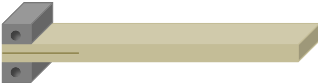
Figura I.18. Geometria dei provini per prove di delaminazione in modo I e II
