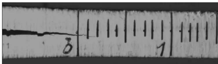
Figura II.17. Griglia laterale di riferimento per individuare l'apice del difetto con passo costante di 1\text{ mm}
