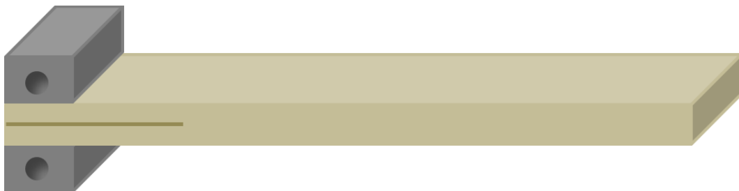
Figura II.5. Geometria dei provini DCB e ENF
