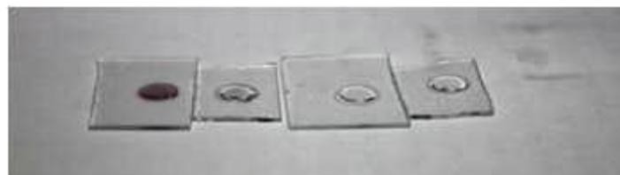
**Figura 3.7** Immagini dei campioni di GelMA foto polimerizzati per 40 secondi in seguito all'inclusione nel prepolimero di diverse densità di HUVEC GFP, ottenute dopo 6 ore di incubazione con MTT
