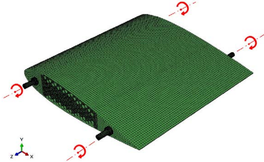
Figura 3.22: Modalità di vincolo per il modello del dimostratore
