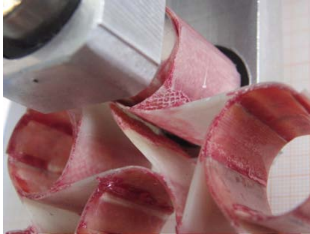
Figura 2.13: Cedimento dell'incollaggio in una cella GFRP [0^\circ/90^\circ] a 17 pelli
