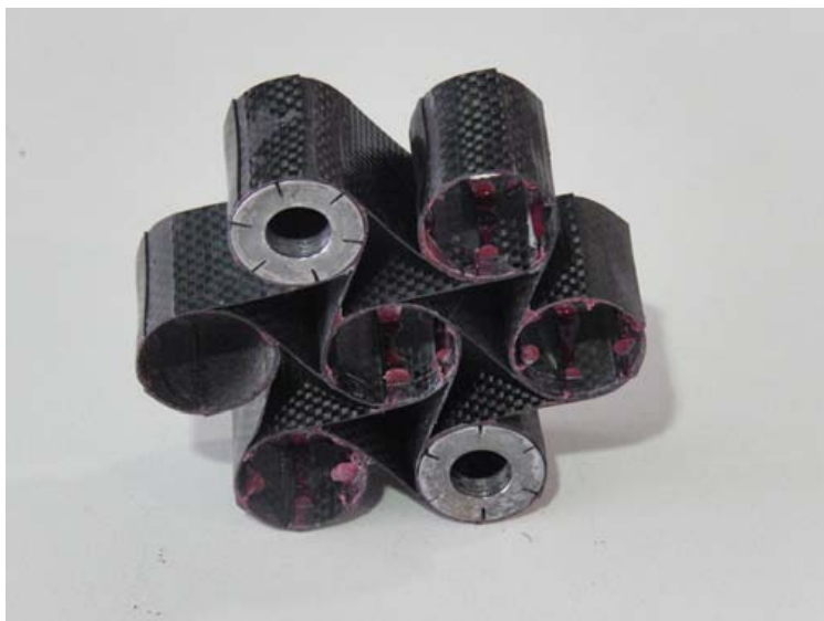
Figura 2.5: Cella con cilindri metallici per il collegamento con la macchina di prova
