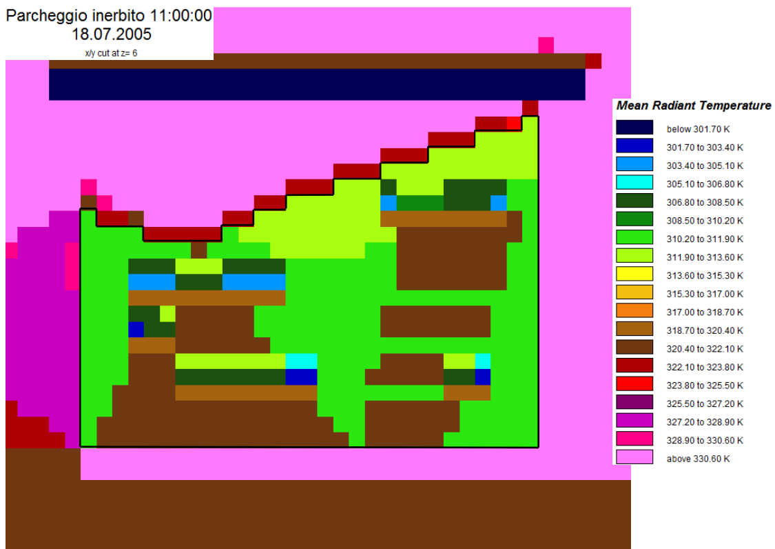
Figura 41: parcheggio inerbito, sezione orizzontale alla quota del parcheggio, distribuzione della temperatura media radiante
