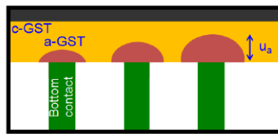
(a) Rappresentazione in sezione della variazione di u_a in seguito all'applicazione di tensioni di programmazione crescenti.
