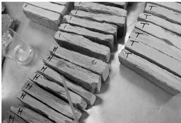
Figura 72 - Particolare della verifica della presenza di carbonati –
