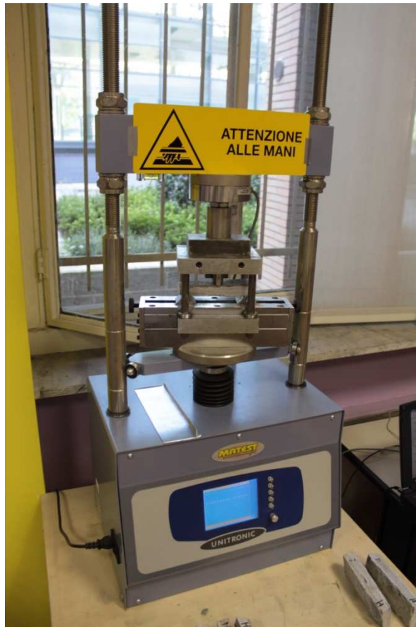
Figura 69 - Strumento di misurazione della resistenza a flessione dei provini -
