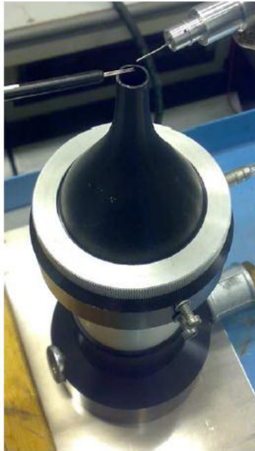
Figura 4.8 Galleria di taratura.
