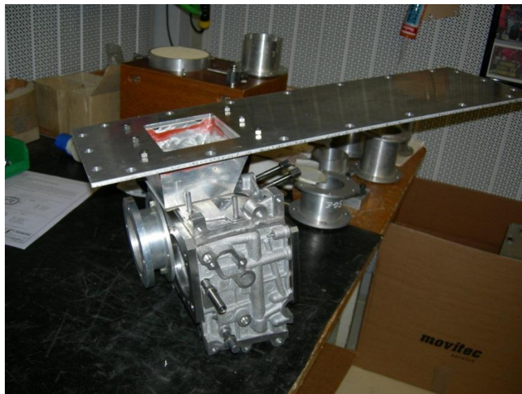
Figura 3.7 Allestimento della testa. È ben visibile il tronchetto che collega la piastra con i condotti di aspirazione.
