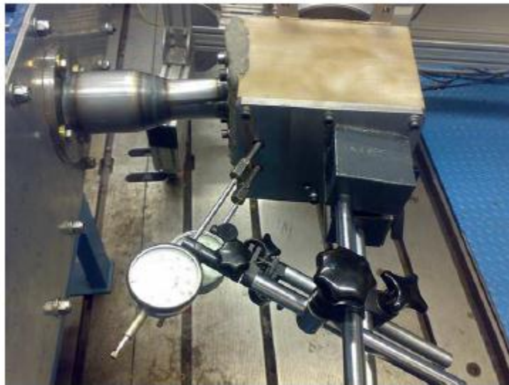
Figura 3.10 Dispositivi di misurazione e regolazione dell'alzata valvola.
