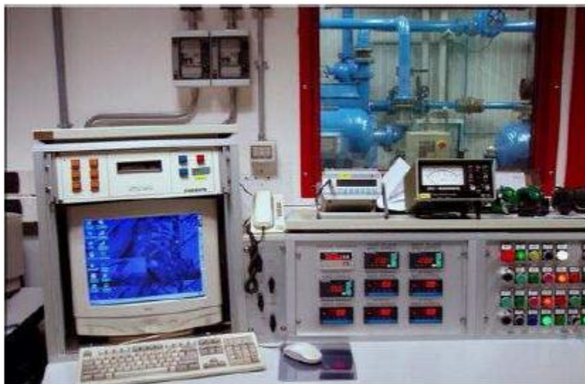
Figura 3.11 Postazione di controllo del banco di flussaggio e interno del banco visibile oltre la schermatura in vetro.
