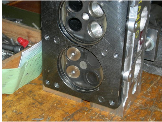
Figura 7.2 Fotografia della testa motore F utilizzata per la prova con le alzate differenziate.
