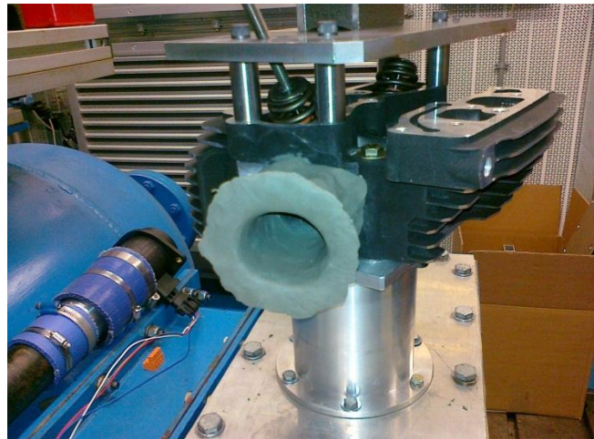
Figura 5.1 Foto della testa motore allestita sul banco aspirato. In primo piano è ben visibile l'imbocco in plastilina "versione 1".
