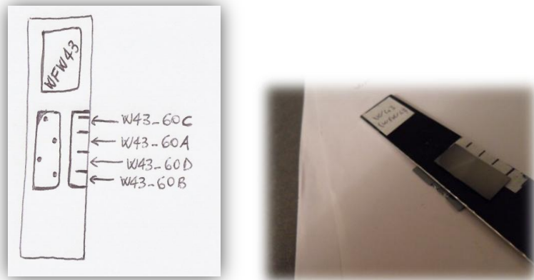
Figura 6.43 Schema della zona di misura con a fianco la foto del campione analizzato.
