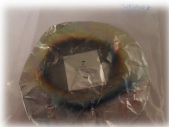
Figura 6.25 Impronta della piuma di deposizione del WFW07, in cui al centro si nota dove era posizionato il campione.
