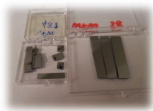
Figura 6.11 Il campione WFW38 è stato spezzato in 5 strisce parallele. Le due analizzate si trovavano ai fianchi delle tre rimaste (a destra) e sono state ulteriormente spezzate (a sinistra) al fine di misurare gli spessori nelle posizioni esatte delle misure spettroscopiche.
