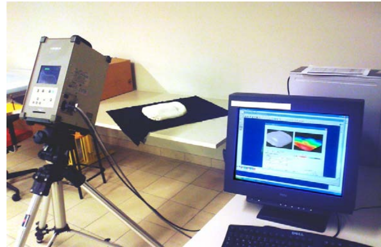
Fig.111 Rilevamento con scanner 3D del calco
