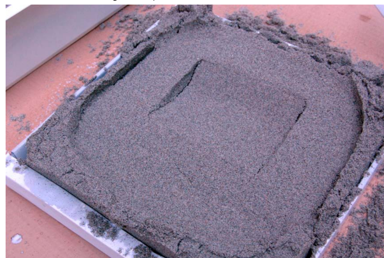
Fig.107 Il calco pronto per la solidificazione con colla
