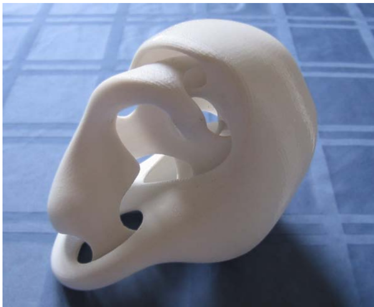
Fig.067 Parte prodotta in FDM con ABS bianco
