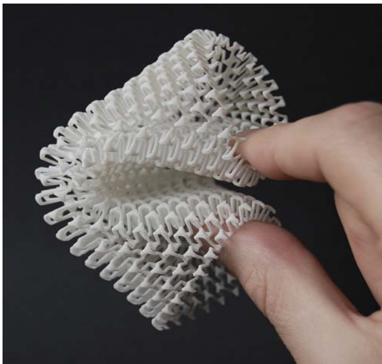
Fig.070 Campione realizzato in SLS con Poliammide
