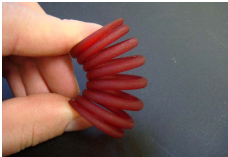
Fig.057 Molla in gomma ottenuta in stereolitografia
