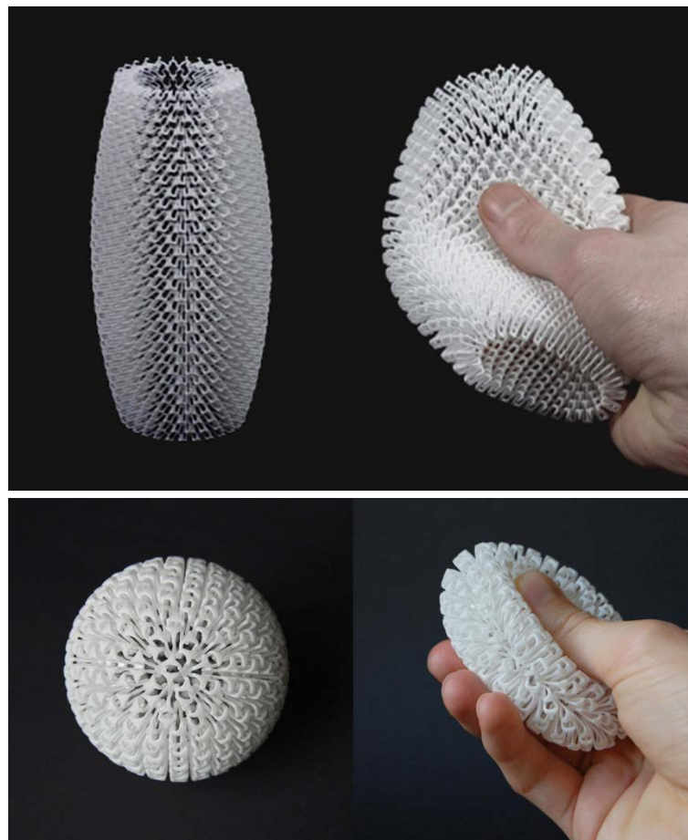
Fig.094 Strutture elastiche sinterizzata in SLS. Principio di molla flettente.
