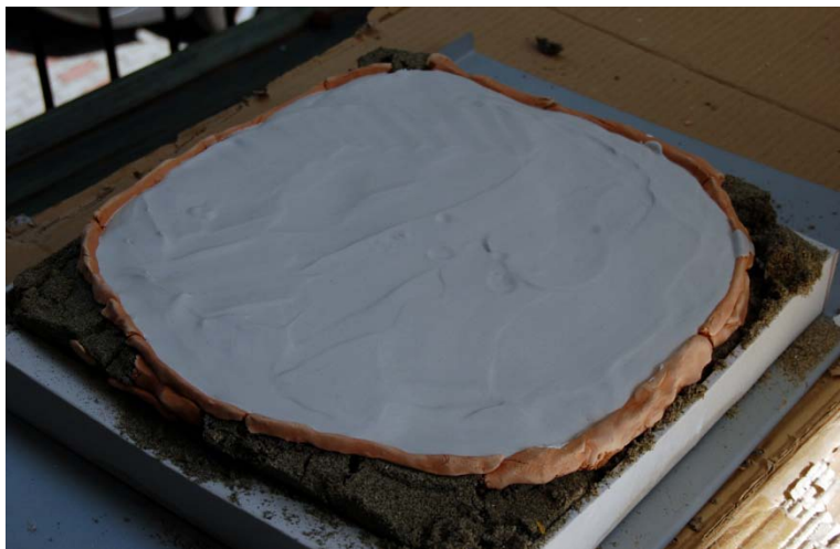
Fig.108 Il gesso appena colato nel calco in sabbia
