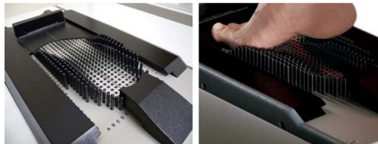
Fig.056 Concetto di contatto puntiforme multiplo negli scanner per pianta del piede
