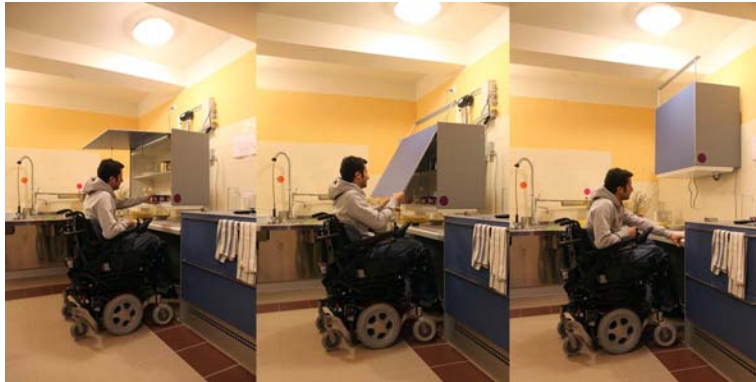
Fig.023 La prova di un ausilio pensile da cucina
