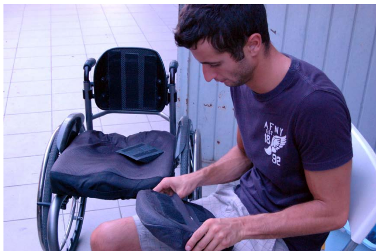
Fig.105 Fase di smontaggio dello schienale
