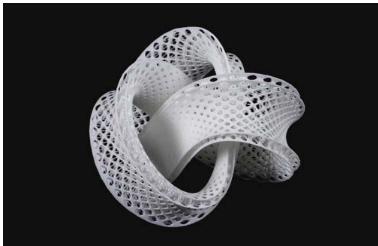
Fig.072 Esempio di parte ottenuta in SLS
