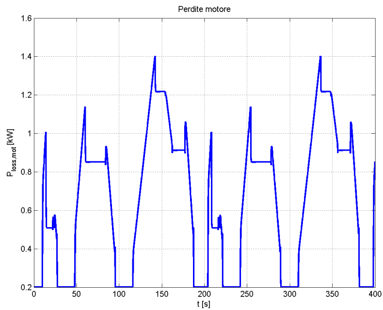
Figura 5.20: Caso 2 - Perdite nel motore elettrico
