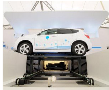
Figura 2.3: Stazione di cambio pacco batterie
