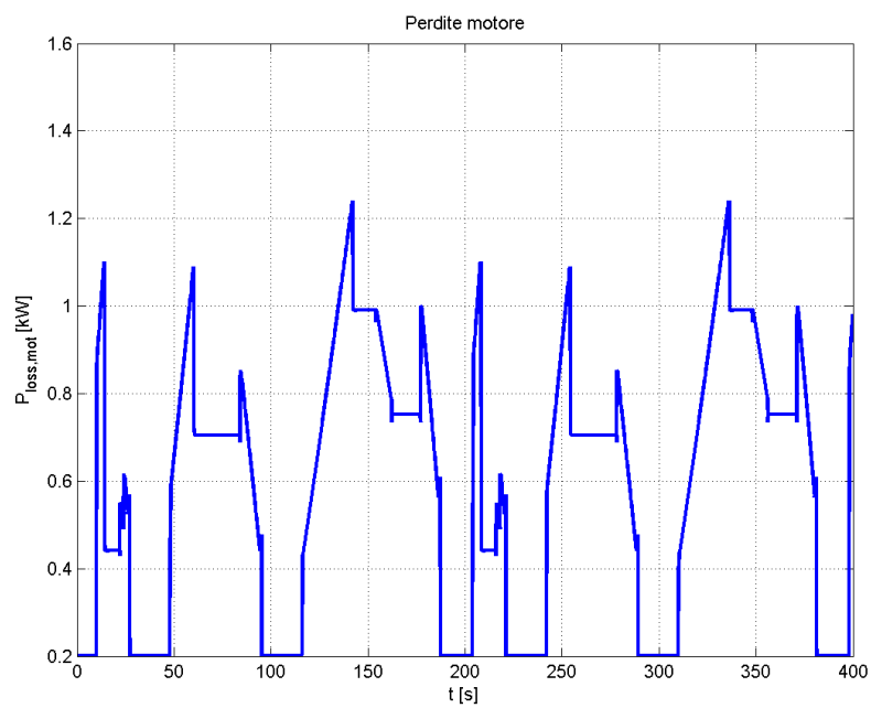
Figura 5.30: Caso 3 - Perdite nel motore elettrico
