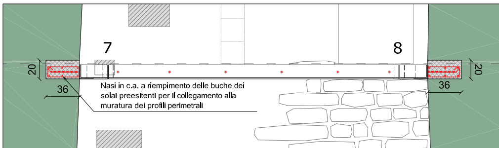
Dettaglio 3 - Parete EST - Livello +8.47 - scala 1:50
