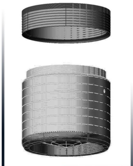
Figura 6.11 : Prototipo di camera di perfusione; immagine tridimensionale ottenuta con il software Autocad Mechanical
