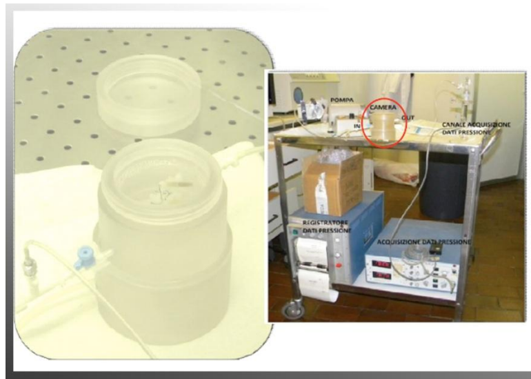
Figura 6.6 : Sistema preliminare completo per le prime prove sperimentali. Si può notare anche il funzionamento fuori dalla cappa a flusso laminare previsto inizialmente per il protocollo D1
