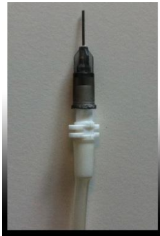
Figura 6.14 : Ago grigio G27 a punta piatta utilizzato per incannulare il catetere verticalmente
