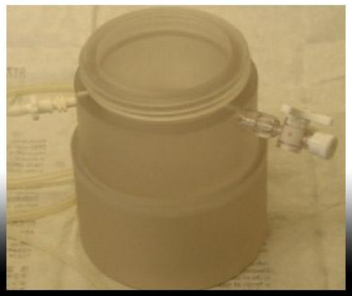
Figura 6.2 : Camera di perfusione utilizzata per le prove preliminari; si possono notare il basamento cilindrico, la chiusura ad avvitamento per il coperchio e i fori passanti attraverso lo spessore della camera, punti di giunzione con il circuito di tubi in silicone. L'incannulamento del rene è ottenuto tramite l'inserimento di una cannula monouso nel foro e la sua congiunzione con il catetere.
