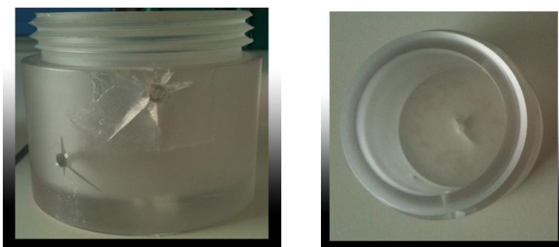
Figura 6.7 : La problematica principale dell'utilizzo della camera di perfusione preliminare; si nota la formazione delle crepe su tutti i fori passanti della struttura
