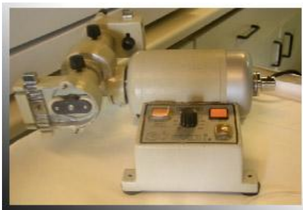
Figura 6.4 : Pompa Roller Multiflex Constant con testina a due rulli. Si può notare la manopola di regolazione della portata e il semplice funzionamento. Sono disponibili due testine per lo svolgimento parallelo di due esperimenti.
