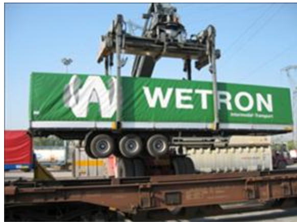
Figura 22: semirimorchio attrezzato con apposite tasche laterali che permettono alle gru di agganciarlo e caricarlo sul carro ferroviario ribassato
