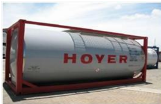
Figura 20: tank container adibito al trasporto di merce liquida o gassosa
