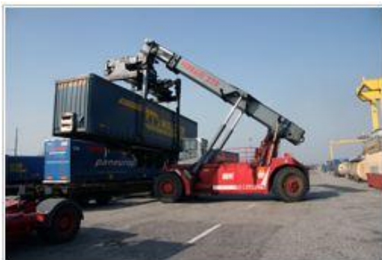
Figura 28: gru gommata mentre solleva un container
