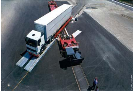
Figura 26: carro rotante per il carico orizzontale del vettore stradale
