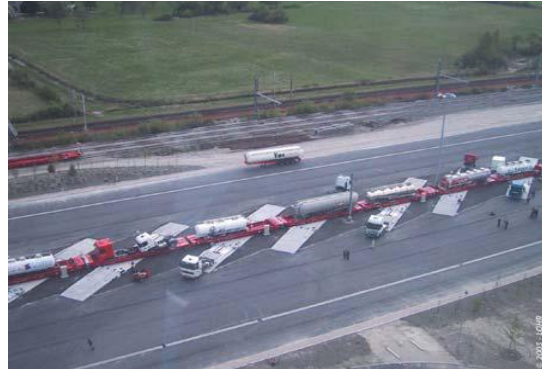
Figura 25: processo di caricamento orizzontale del treno
