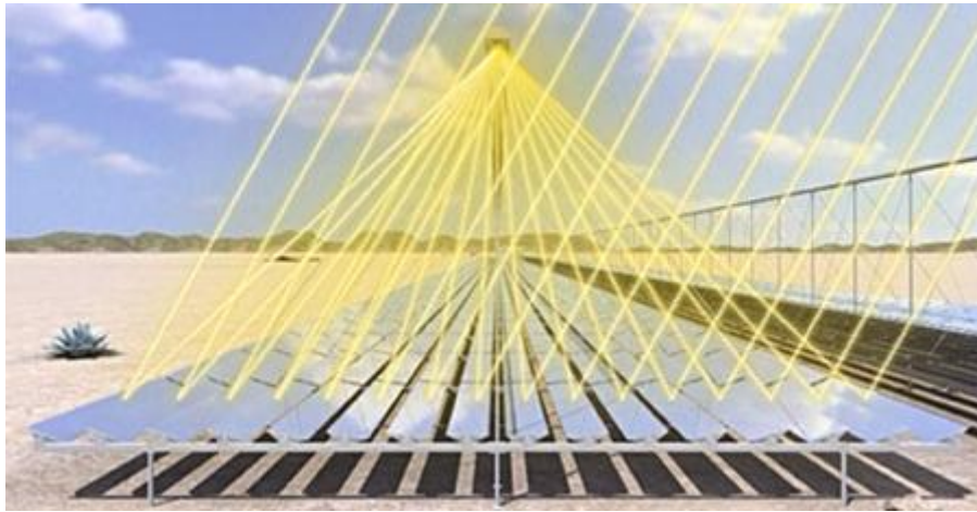
Figura 5.38: Raggi proiettati su un collettore Fresnel
