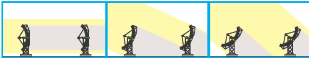
Figura App.1.10: ombreggiamento reciproco per un campo costituito da specchi parabolici [18]
