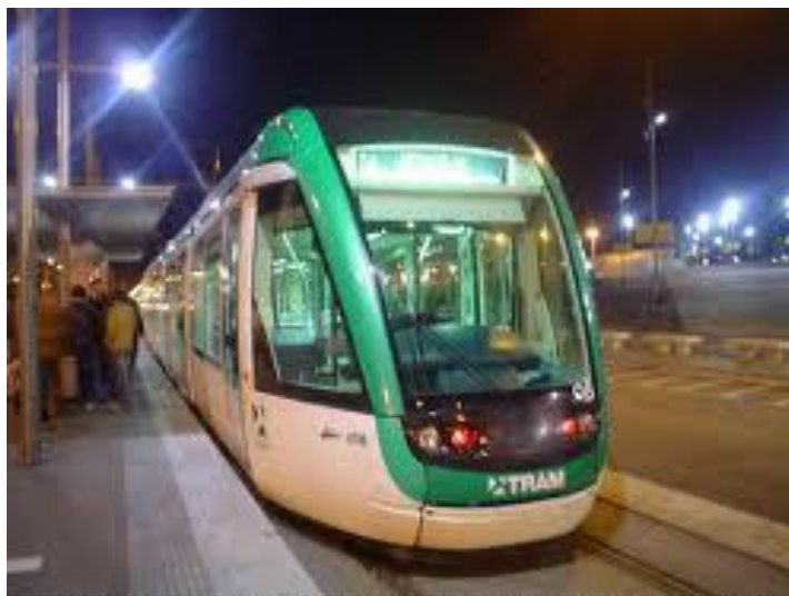
Figura 3.10 - Esempio di veicolo a pianale ribassato con carrelli senza ralla, impiegati a Barcellona.
