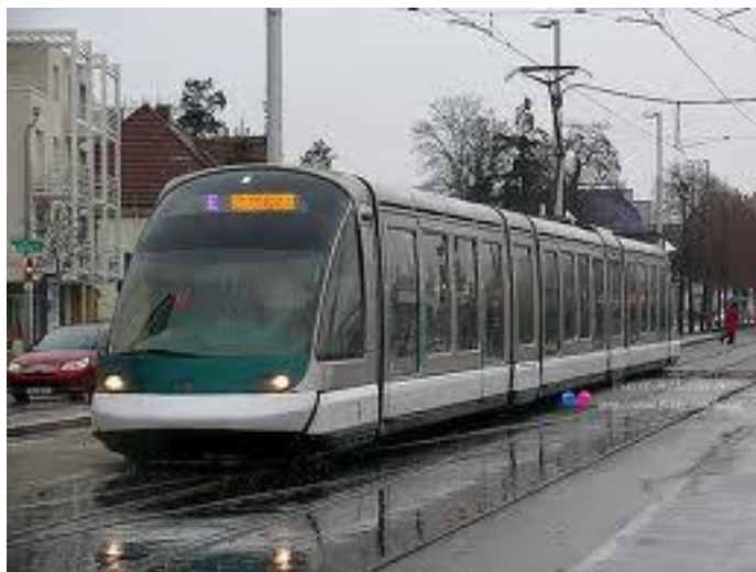
Figura 3.11 - Elettrotreno a pianale ribassato Eurotram con carrelli senza ralla, impiegato a Innsbruck.
