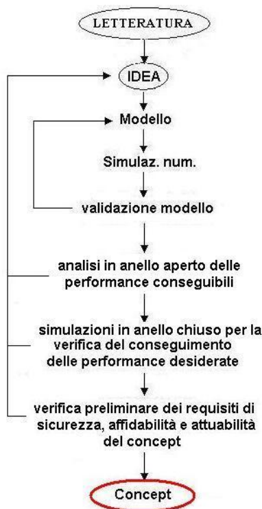
Figura 2.19 - Metodologia adottata per lo studio delle proposte di sterzatura degli assi dei carrelli ferroviari e tranviari, presentate nel lavoro di tesi.
