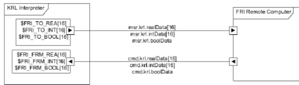
Figura 2.13: variabili FRI per la comunicazione tra pc remoto e programma KRL
