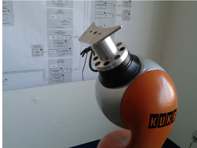
Figura 4.29: geometria utilizzata per la realizzazione del task di inserzione per la verifica della generalità di applicazione della strategia
