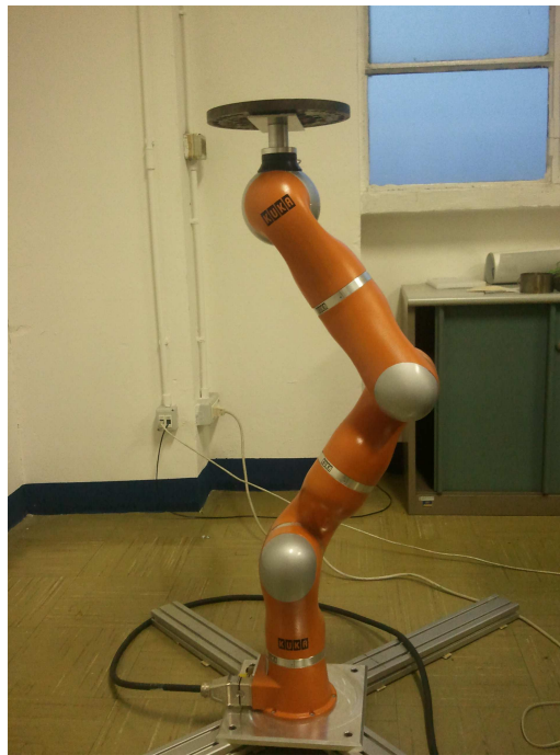
Figura 3.22: verifica parametri di rigidzza realizzati dal controllo in impedenza nello spazio operativo
