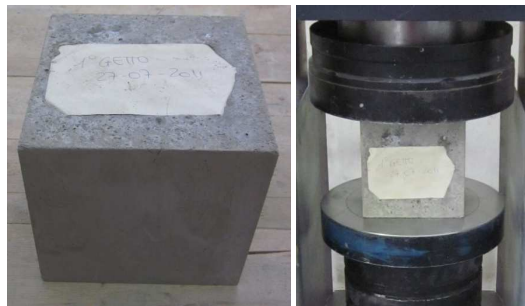
Figura 6.3: Cubetto 150x150x150 mm 3 standard testato a compressione
