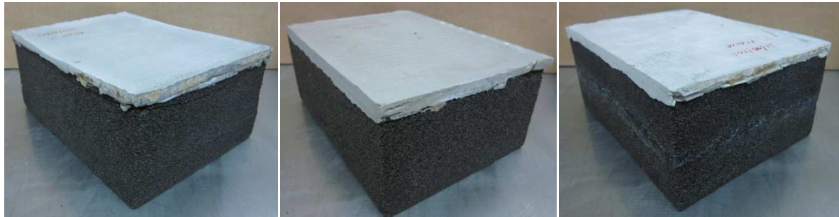
Figura 9.3: Travetti dopo la maturazione in a) camera umida; b) forno a 60°C; c) acqua
