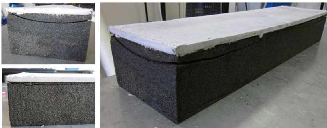
Figura 9.2: Particolari della propagazione della fessura nel Foamglas ®
