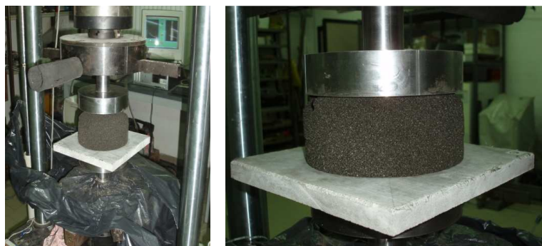
Figura 8.1: Set-up della prova a compressione del Foamglas ®
