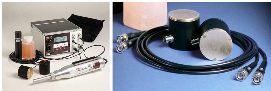
Figura 8.5: Centralina Control UPV E49 e la coppia di trasduttori
