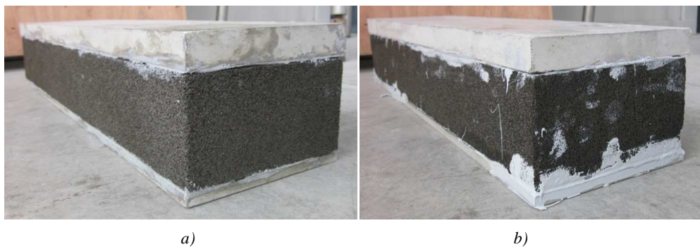
Figura 10.5: Prototipo 2 completo con: a) Adesilex PGI; b) Norphen PU
