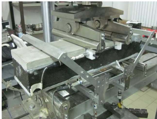
Figura 10.13: Set-up di prova dei sandwich: applicazione reale
