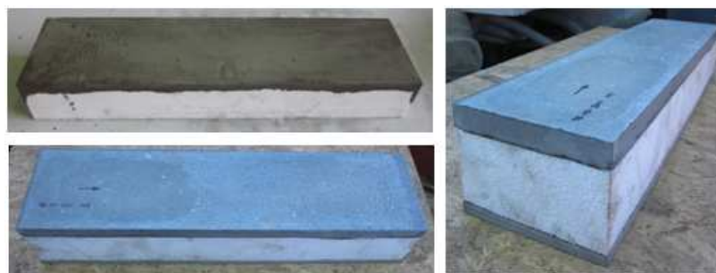
Figura 10.1: Fasi di realizzazione dei travetti con core in polistirene
