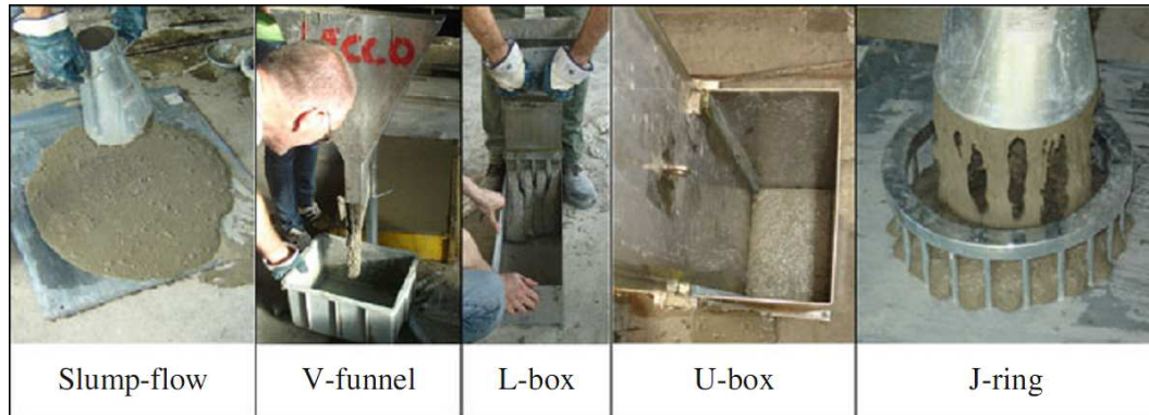
Figura 6.2: Prove allo stato fresco della matrice UHPFRC [47]
