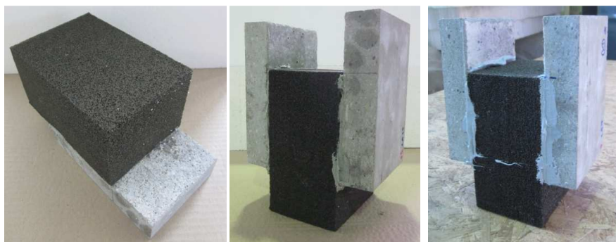
Figura 9.10: Fasi di produzione del provino d'aderenza con core in Foamglas®
