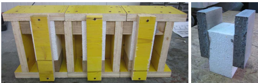
Figura 9.9: Il cassero impiegato per realizzare i tre provini in polistirene
