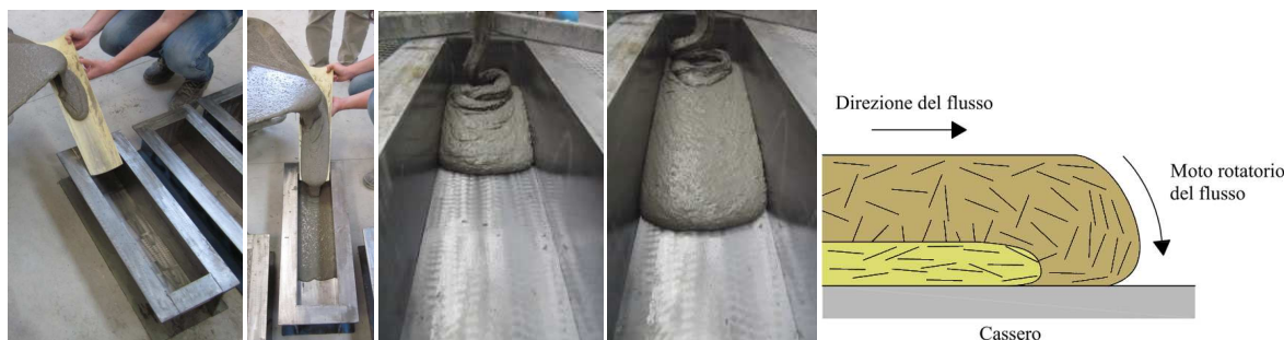
Figura 6.6: Modalità di getto dei travetti strutturali orientati e istantanee del flusso della matrice lungo il cassero
