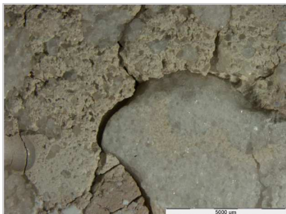
Figura 6.32 Fessurazione nella zona di separazione fra aggregato e pasta
