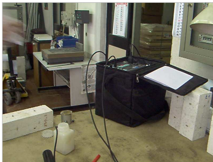
Figura 4.53 Attrezzatura per l'esecuzione della prova UPV
