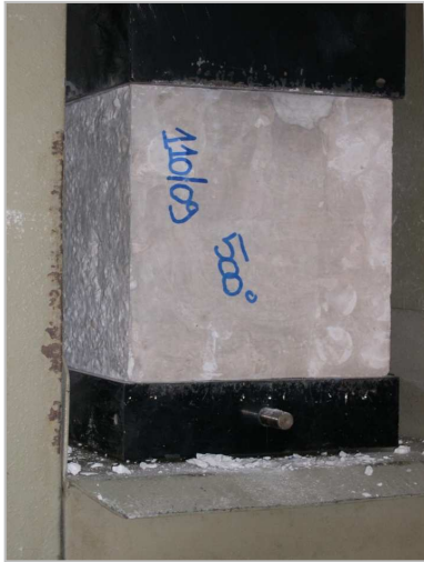
Figura 4.6 Provino cubico posizionato nella cella di carico
