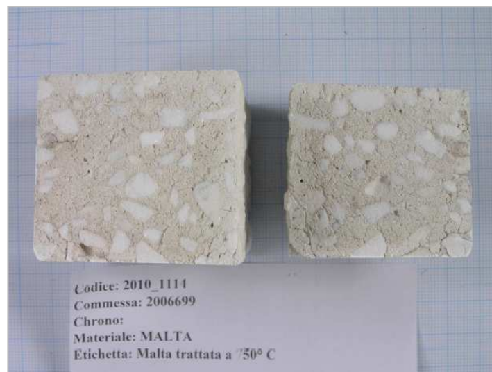
Figura 6.29 Provino trattato a 750°C
