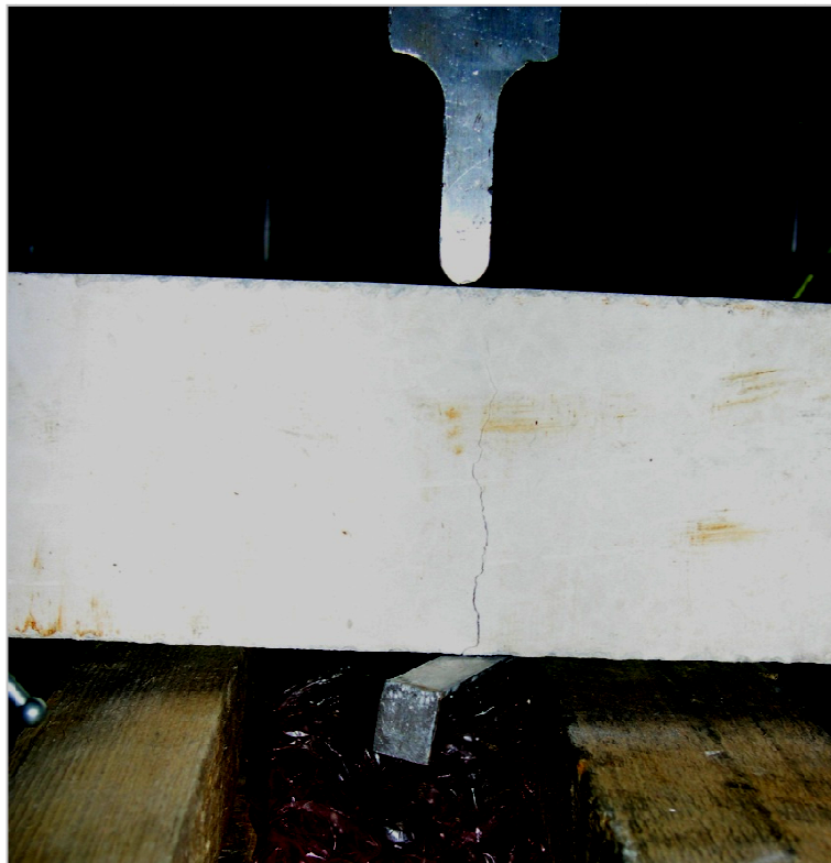
Figura 4.29 Formazione della fessura
