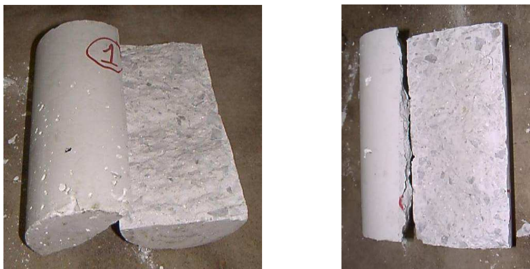
Figura 4.48 Rottura del provino secondo la linea di carico
