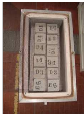
Figura 4.2 Parte inferiore del forno per l'alloggiamento dei provini
