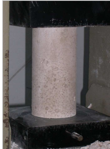
Figura 4.7 Provino cilindrico posizionato nella cella di carico
