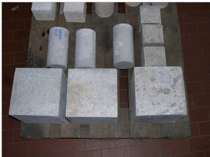
Figura 4.5 - Provini cubici e cilindrici per le prove di compressione
