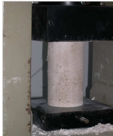
Figura 4.9 Provino cilindrico: prova in esecuzione
