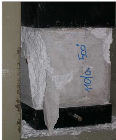
Figura 4.8 Provino cubico: prova in esecuzione
