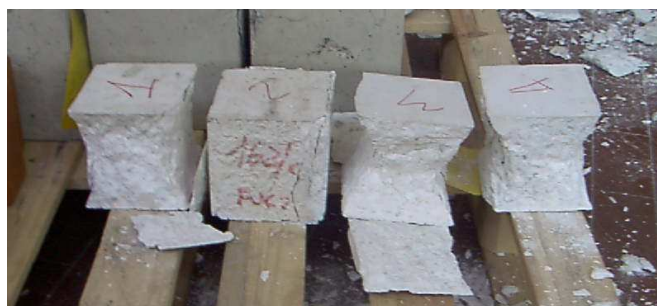
Figura 4.14 Esempi di rottura a clessidra di un provini cubici
