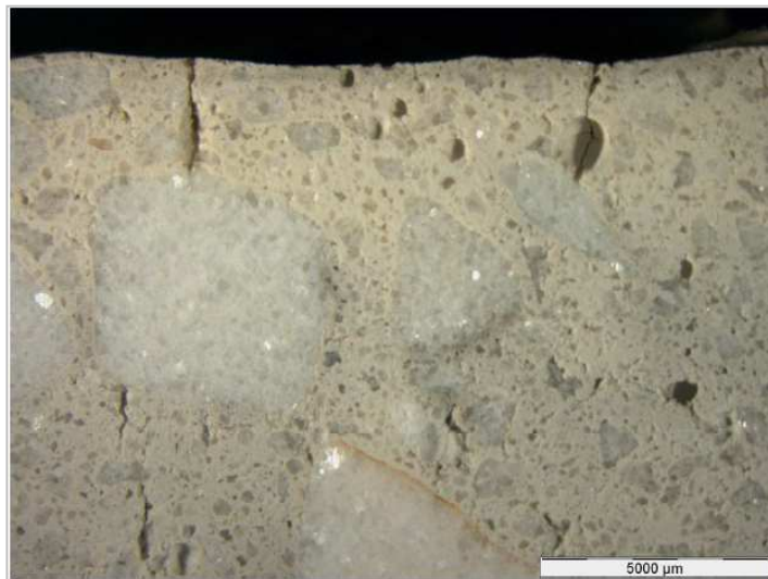
Figura 6.26 Formazione di fessure lungo i bordi del provino
