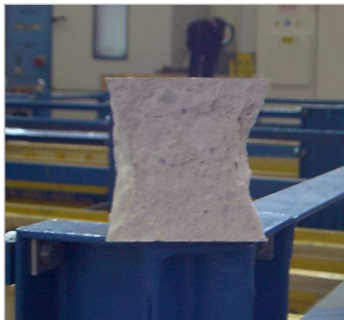
Figura 4.13 Modalità di rottura soddisfacenti per provini cilindrici
