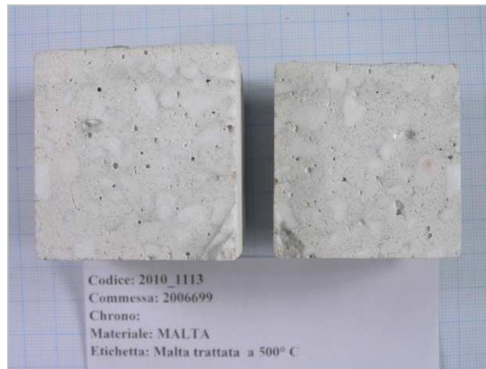
Figura 6.24 Provino trattato a 500°C
