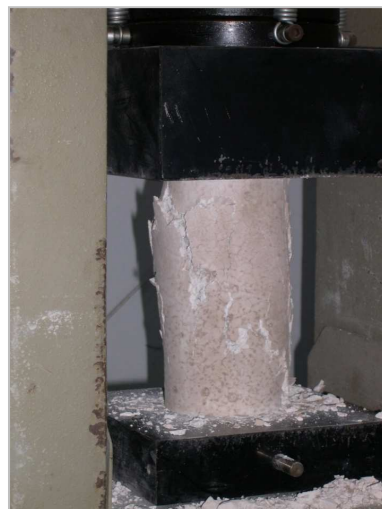
Figura 4.11 Provino cilindrico: prova conclusa
