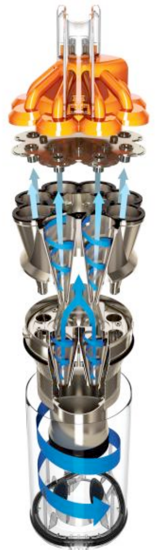
Fig 26: Schema Funzionamento 3 Level Root Cyclone
