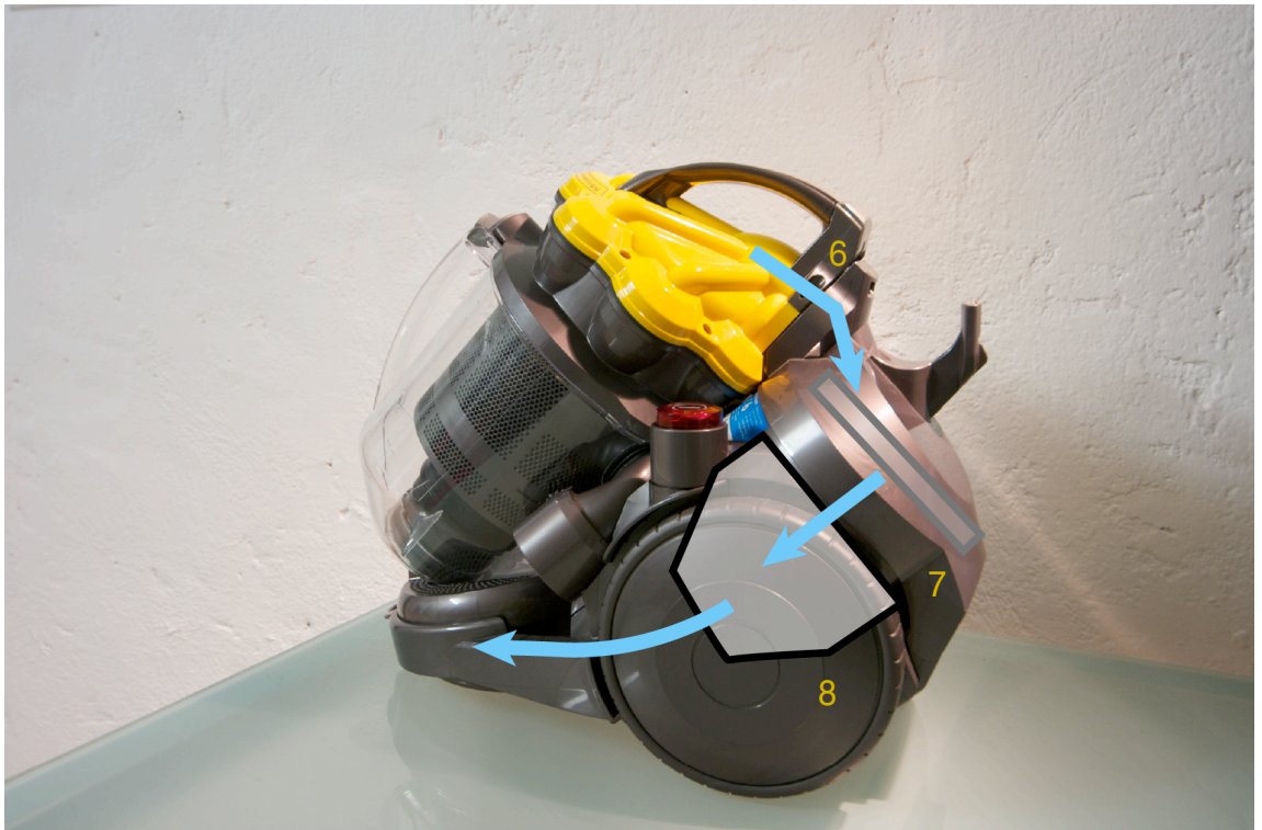
FIG 83: percorso dell'aria nel vano motore
