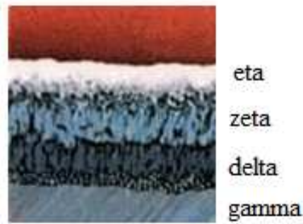
Figura 8: strati del rivestimento eseguito per zincatura.
