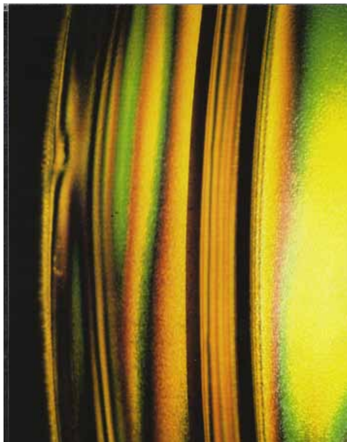
Fig. 5.21 Autotensioni sul sedile (particolare aletta anteriore)
