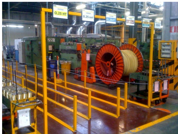
Figura 41:FIFO per la gestione carrelli di bobinatura.
