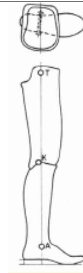
Figura 5.8. Procedure di allineamento statico - il metodo americano
