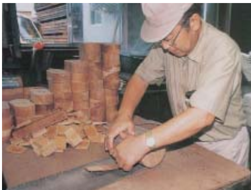
La tecnica curvare a legno, un artigiano di Mage-wappa Figura1
