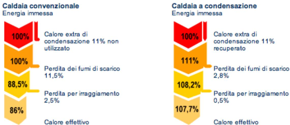
Fig. 19: Confronto fra i rendimenti utili di una caldaia tradizionale e di una a condensazione
