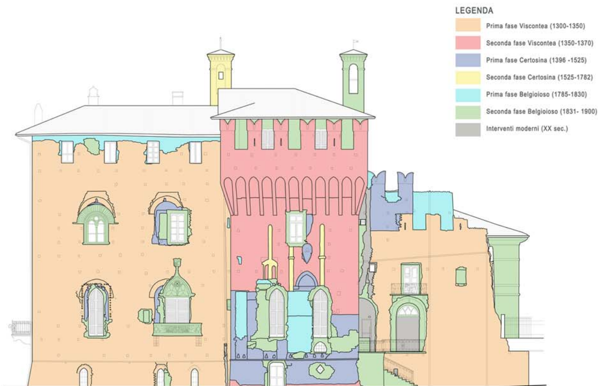
Fig. 3.19 Rappresentazione delle fasi costruttive sul prospetto Ovest.
