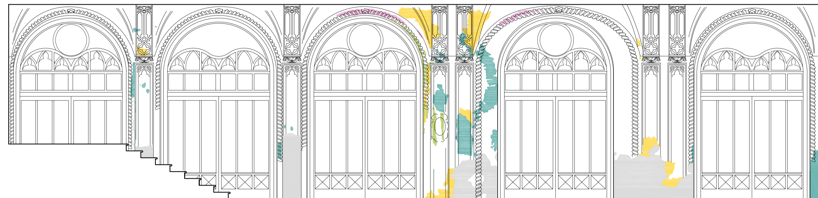
MAPPATURA DEL DEGRADO PARETE EST
