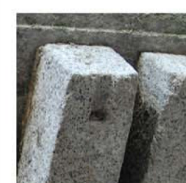
Elemento lapideo in granito di provenienza alpina. Utilizzato nella realizzazione di balconi.
