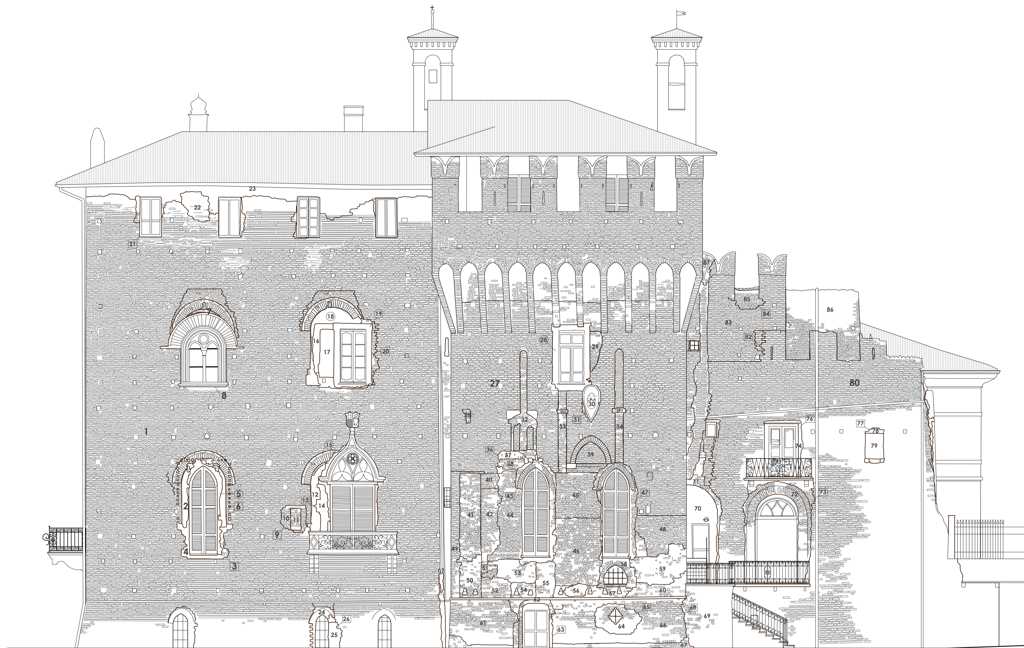
MAPPATURA USM PROSPETTO OVEST
