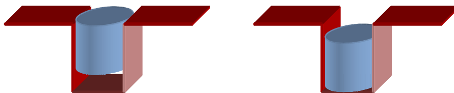
Figura 5.7: A sinistra, la posizione corretta del microfono in linea con la superficie, mentre a destra la modalità sbagliata (o, meglio, che potrebbe causare un deterioramento delle condizioni) di posizionamento
