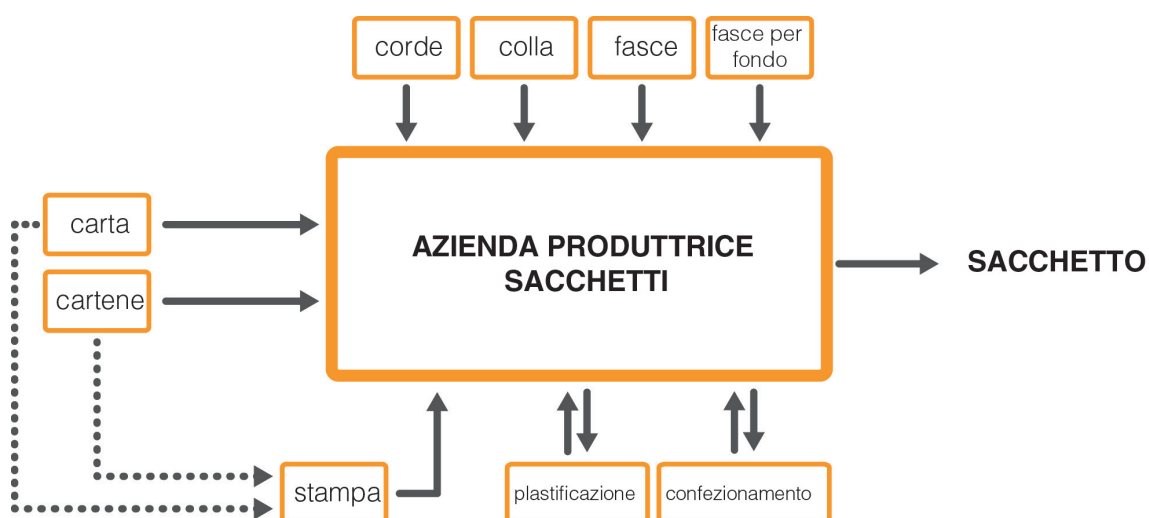
Funzionamento di una piccola sacchettificio artigianale
