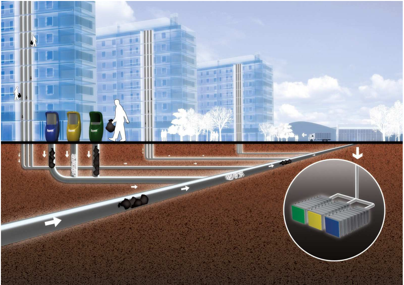
Figura 35_ Esempio di Automatic Waste System
