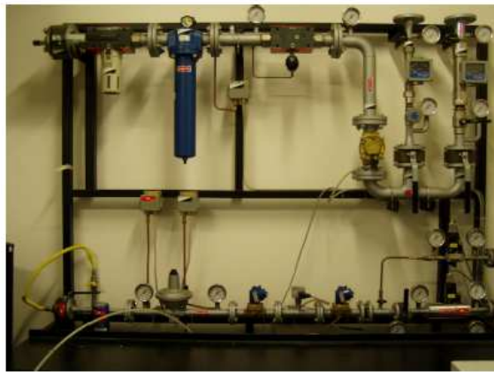
Figura 3.5 Impianto di alimentazione
