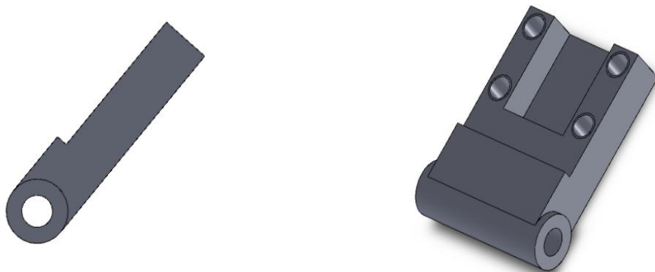
Figura 2.25. Modello CAD delle cerniere per il fissaggio del Provino I all'attrezzatura di prova.
