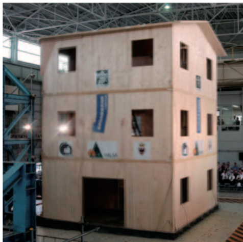
sismica di Tsukuba (2006) su un edificio a tre piani in X-LAM
