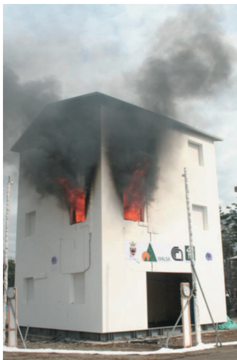
98. Foto della prova al fuoco effettuata nel marzo 2008 al Building Research Institute (BRI) di Tsukuba, in Giappone
