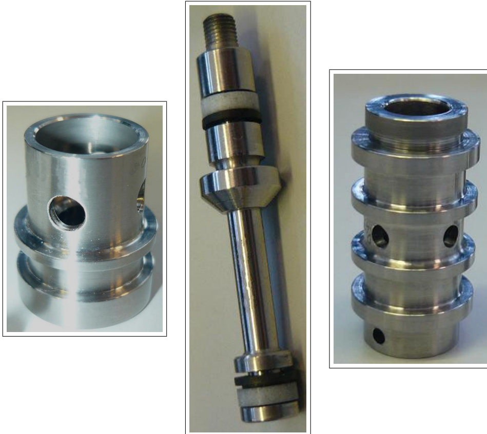
Figura 5.2: Componenti della Valve Lock Nel centro è mostrata un'immagine del pistone mentre ai lati le immagini delle camicie.
