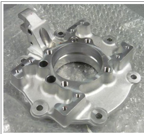
Figura 4.4: Flangia e installazione della stessa sul servocomando (non sono ancora presenti le servovalvole)
