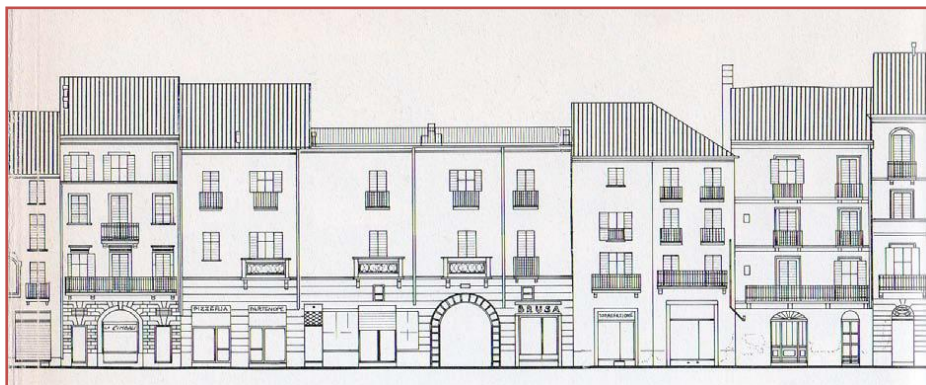
F.14. prospetti su corso libertà tipologia casa mercantile. Si può notare la "portina" nell'ultima parte a destra dell'immagine. Le aperture dei passi carrai e le vetrine
