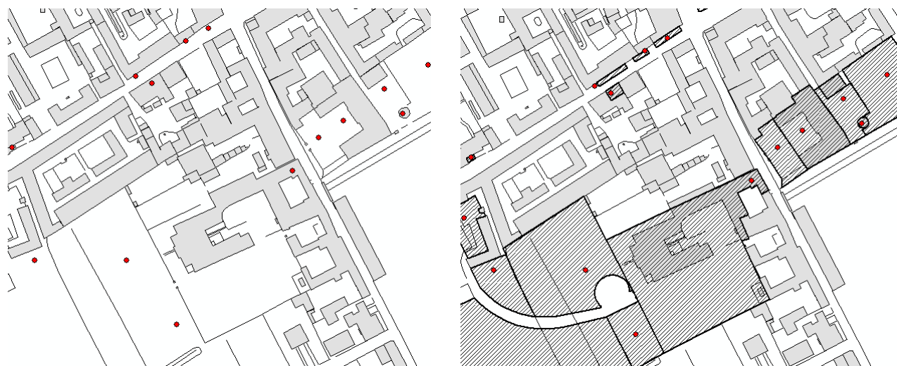
Fig. 23 – Rappresentazione puntuale dei servizi censiti (a destra) e ricostruzione delle geometrie in ambiente Gis (a sinistra).
