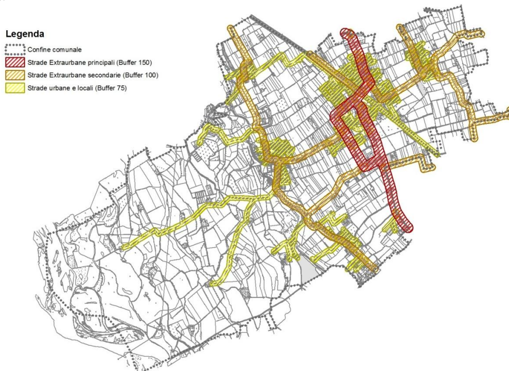
Fig. 366 – Gerarchia stradale del sistema viabilistico a Robecco sul Naviglio e relativo raggio topologico.
