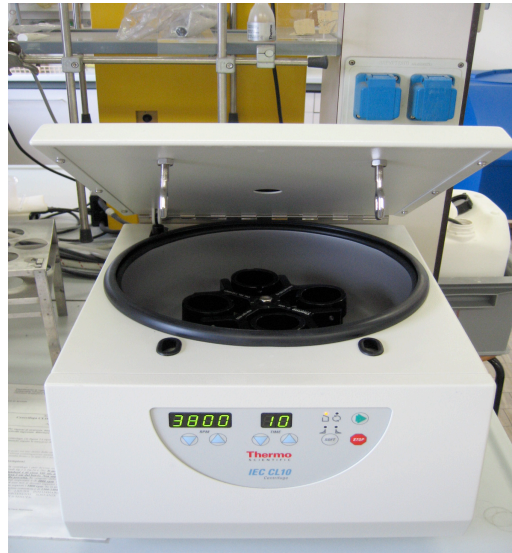
Figura 4.5 Centrifuga utilizzata per la prove di laboratorio.
