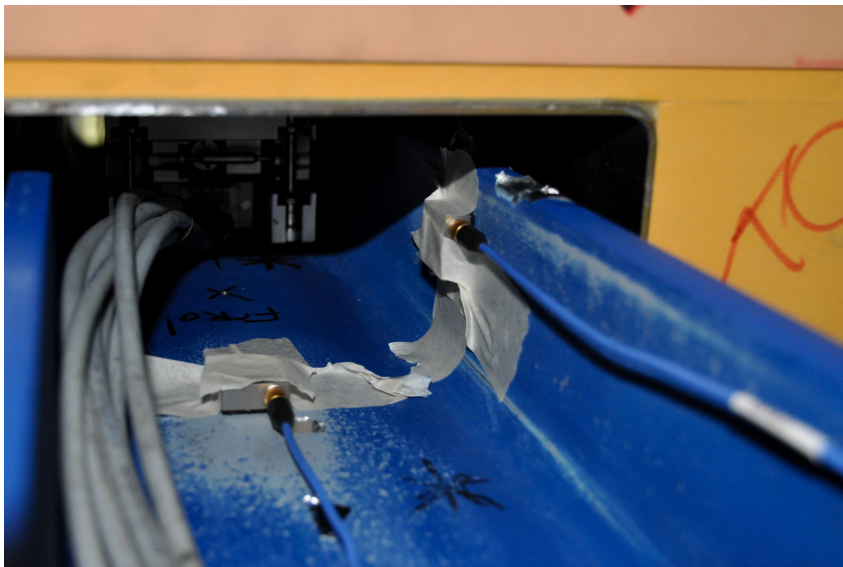
Figura 4.14: Accelerometri posizionati sulla trave
