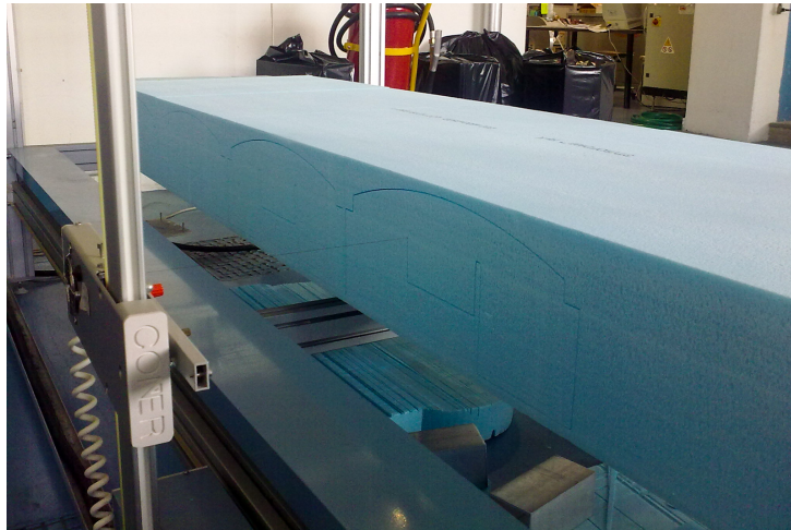
Figura 4.5: Taglio al filo caldo della sezione inerte
