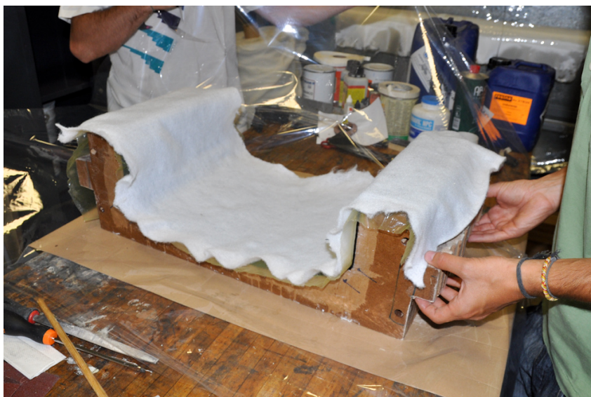
Figura A.4: Applicazione del sacco a vuoto sopra lo strato di breather e al film di microforato
