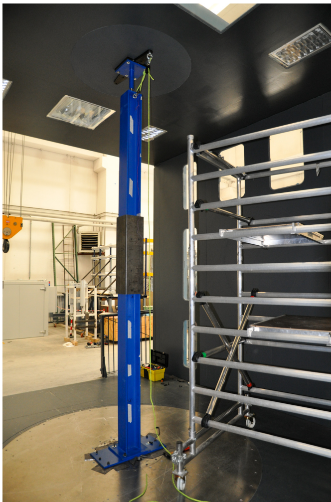
Figura 4.10: Trave a I in camera di prova, si notano: il sistema di carrucole in alto e il tubo a sezione quadrata calzato sopra la bilancia
