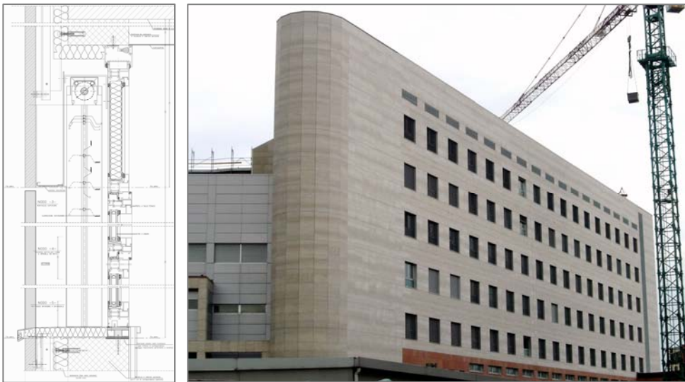
Dettaglio della parete ventilata del Blocco "B" e Blocco B
