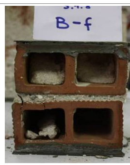
Figura 342 – Prova di rottura sul campione Bf. a) campione strumentato in prova; b) provino dopo la rottura.
