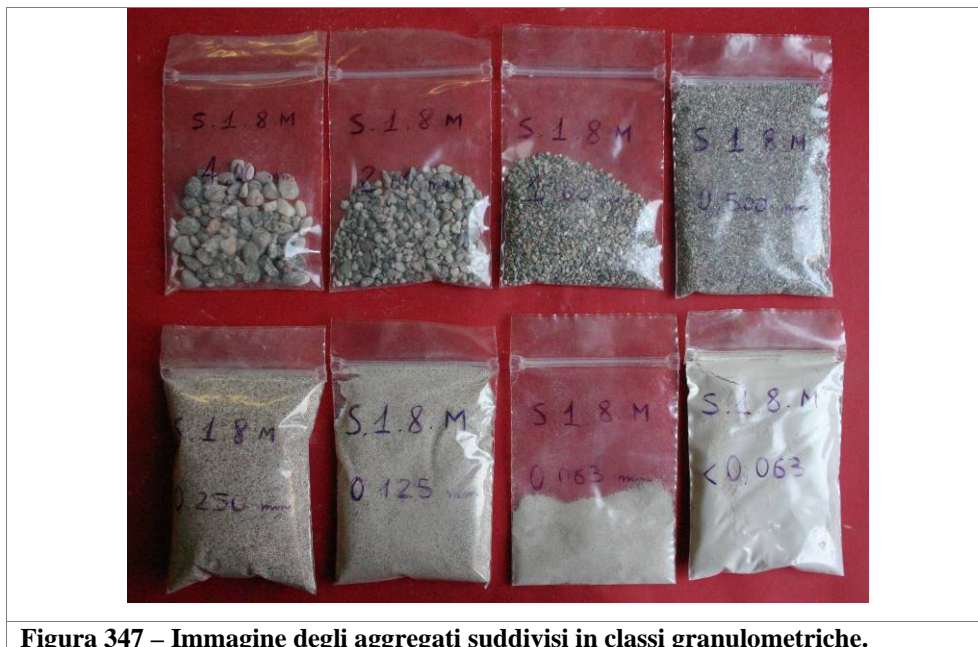
Figura 347 – Immagine degli aggregati suddivisi in classi granulometriche.
