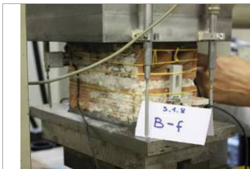
Figura 342 – Prova di rottura sul campione Bf. a) campione strumentato in prova; b) provino dopo la rottura.
