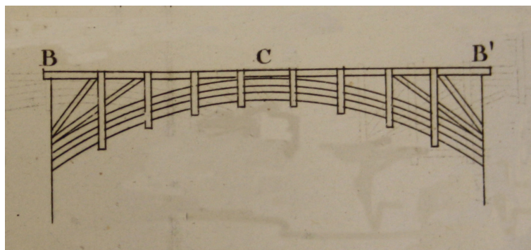
Figura 85. Ponte ad arco in legno. L'arco è formato da una serie di elementi sovrapposti e bloccati da flange.
