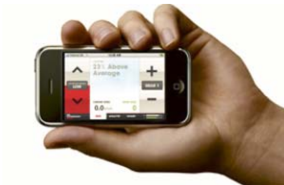
Figura 21 - I ciclisti controllano la quantità di potenza di cui hanno bisogno dal motore ausiliario, cambiano marcia e ottengono aggiornamenti in tempo reale attraverso la schermata 'Ride'.
