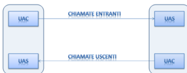
Figura 24 - Schema emulazione chiamate entranti e chiamate uscenti.
