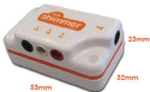
Figura 3.7: Mote Shimmer con ECG utilizzato dal sistema di rilevamento
