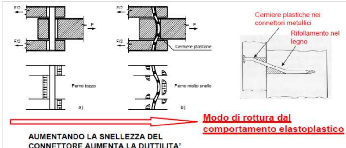
Figura 4.28: Duttilità delle connessioni a gambo cilindrico [M.A. Parisi, Corso di costruzioni in zona sismica, Lez. 24]
