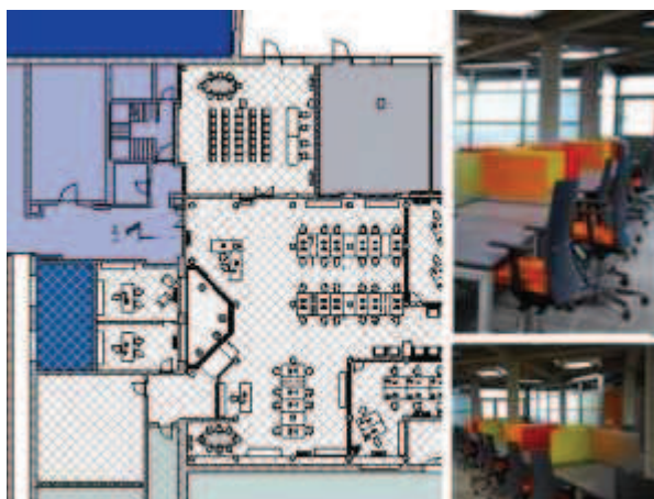
Figura 17- esempio a confronto di tavola in BIM e dell'opera compiuta
