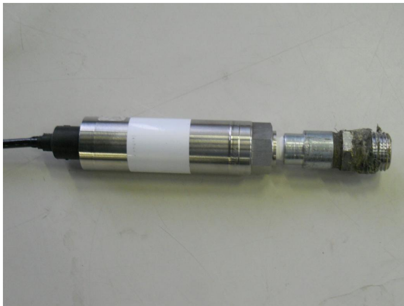
Figura 2.7 Trasduttore di pressione.
