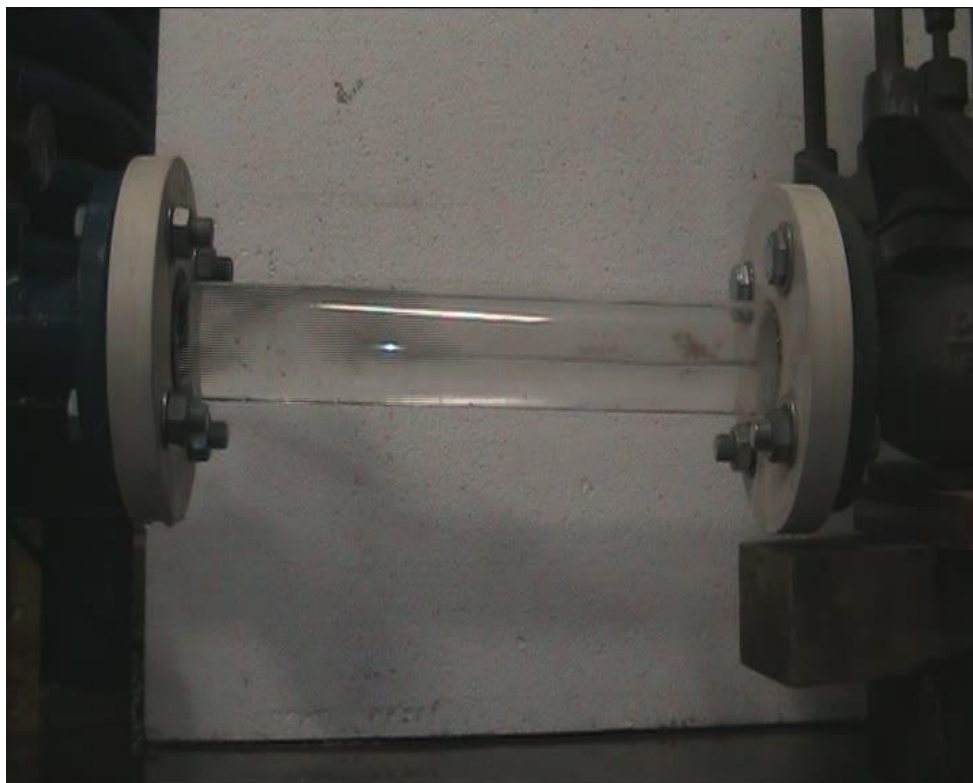
Figura 4.41 Portata 180 litri/minuto: il fluido sta tornando indietro verso la valvola contro cui si infrange.
