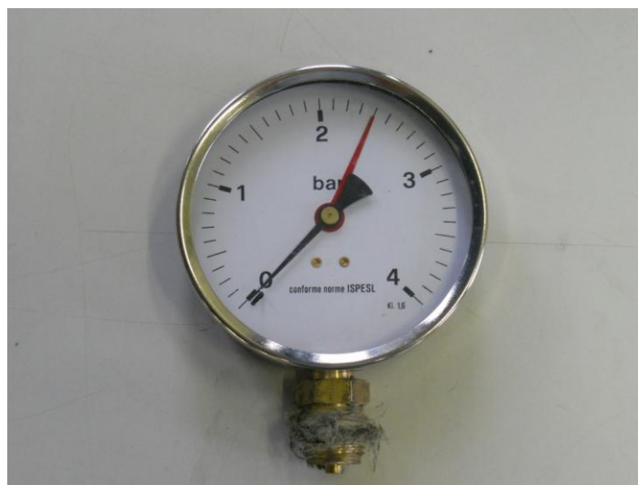
Figura 2.10 Manometrico metallico con fondo scala 4 bar.
