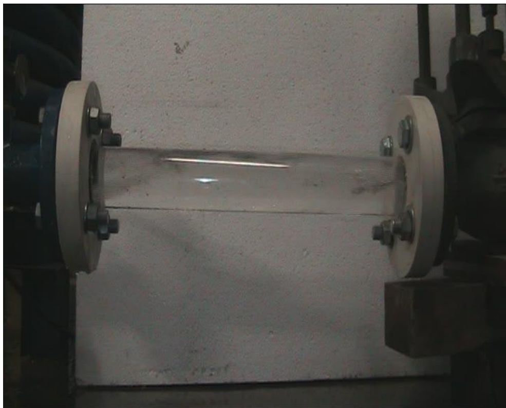
Figura 4.39 Portata 141 litri/minuto: il fluido sta tornando indietro verso la valvola contro cui si infrange.
