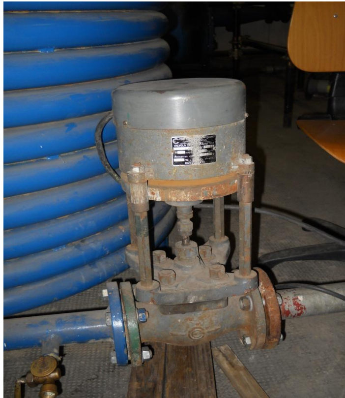
Figura 2.4 Elettrovalvola a chiusura molto rapida.
