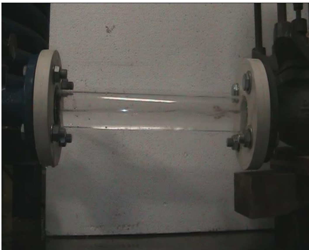
Figura 4.38 Portata 141 litri/minuto: la valvola è appena stata chiusa ed il tubo non è più pieno.
