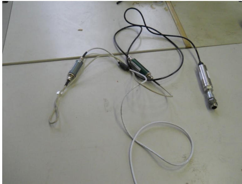
Figura 2.8 Il trasduttore è dotato di amplificatore di segnale e di potenziometro.
