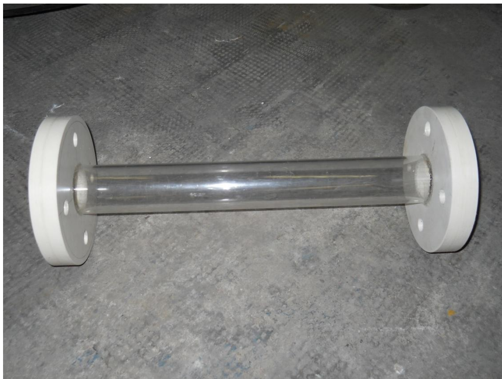
Figura 4.36 Tubo in pléxiglas con flange realizzate in PVC.
