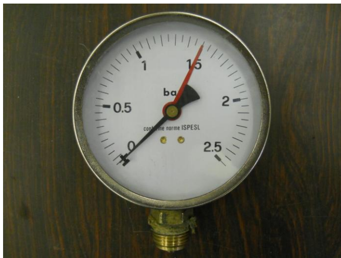
Figura 2.11 Manometro metallico con fondo scala 2.5 bar.
