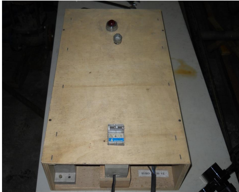
Figura 2.5 Scatola elettrica sulla quale è installato l'interruttore che apre e chiude la valvola elettricamente.
