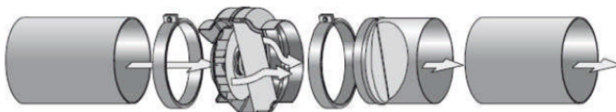
Figura 3.2. Simulatore di generatore di calore.
