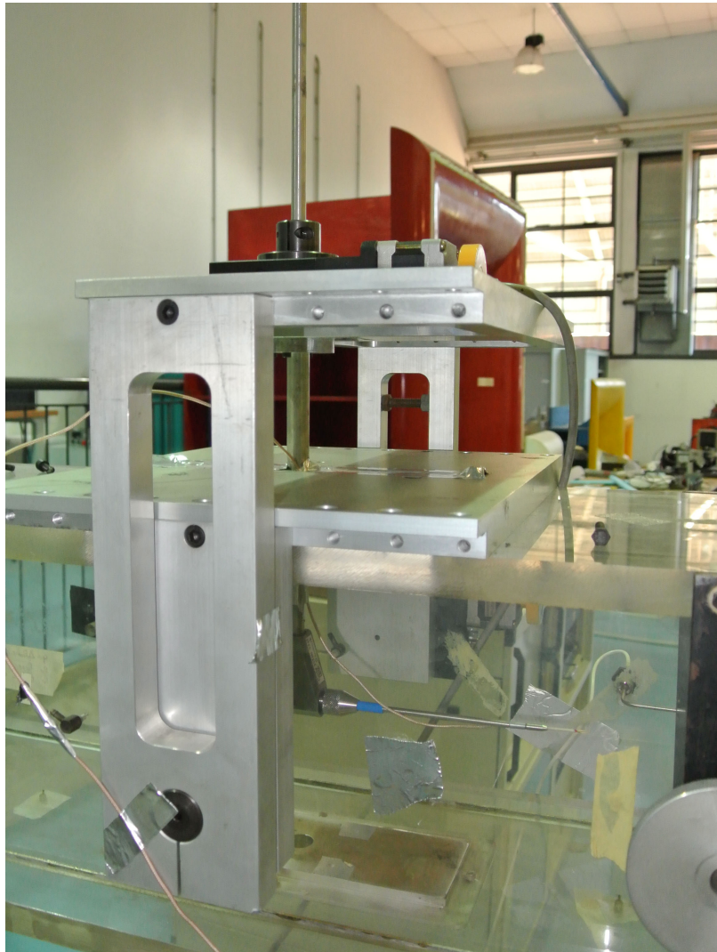
Figura 4.2. Particolare del castelletto di supporto delle sonde
