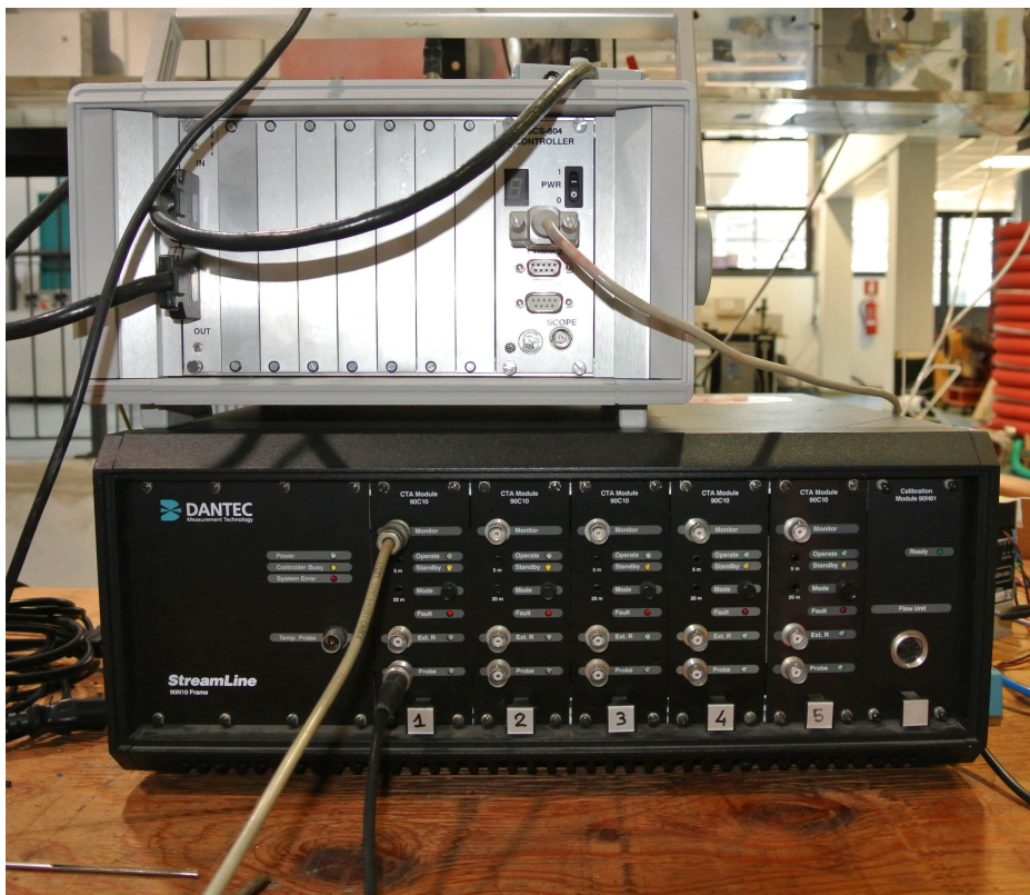
Figura 4.3. Vista frontale dell'anemometro Dantec StreamLine (in basso) e del filtro anti-aliasing Alligator (in alto)
