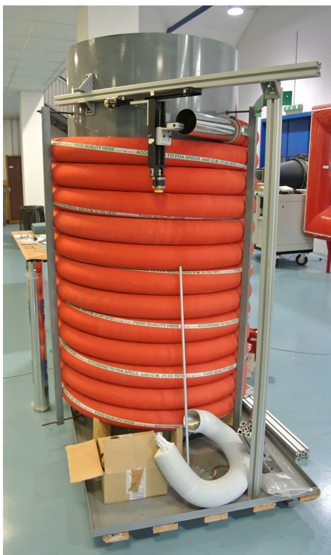
Figura 4.9. Condotto elicoidale realizzato presso il Laboratorio di Aerodinamica
